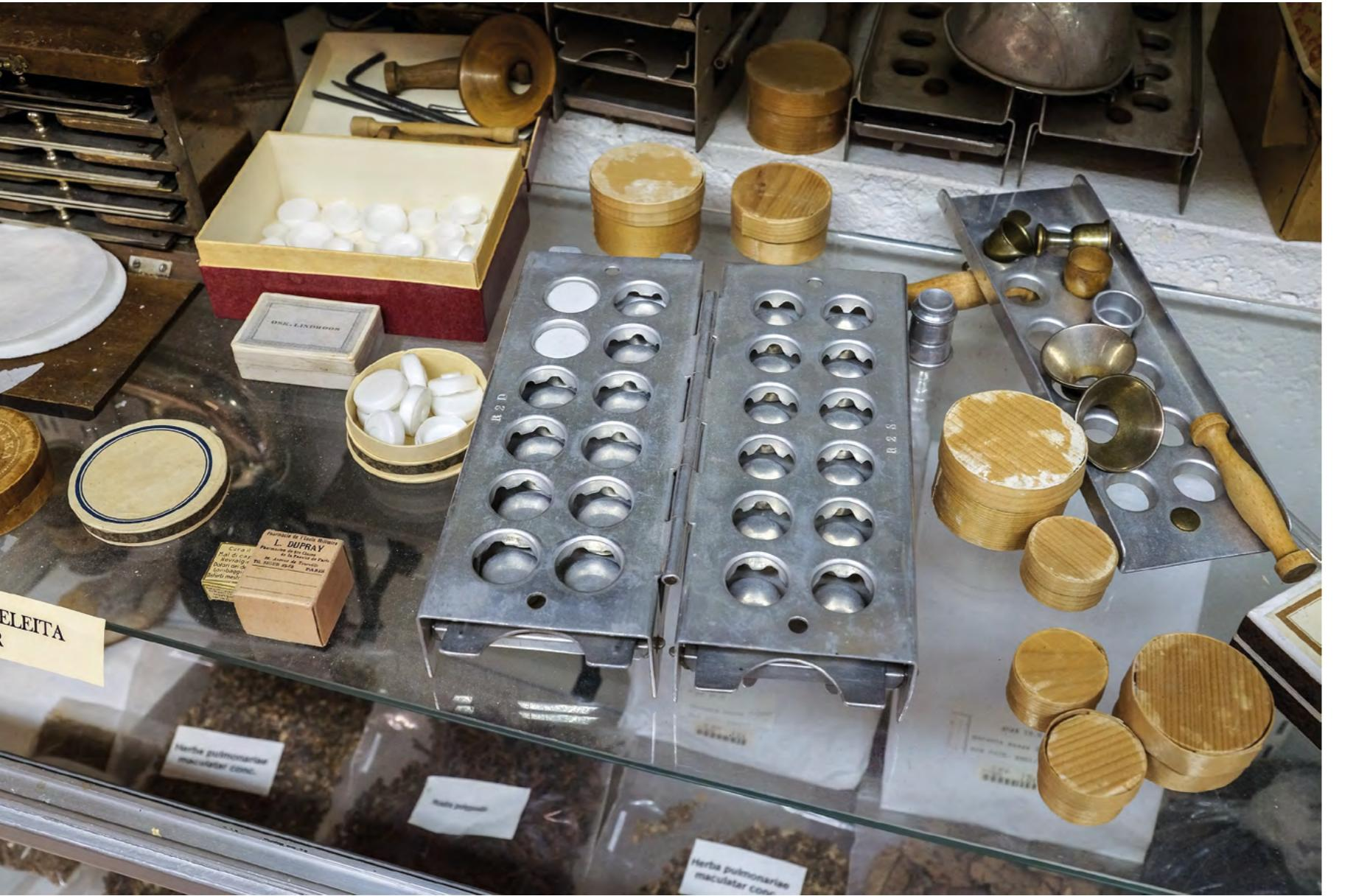
■ Kapseli- eli oblaattikoje, jolla tärkkelystaikinasta (oblaatti- eli öylättitaikinasta) voitiin valmistaa useampia kapseleita yhtä aikaa. Kuvassa on myös muita kapseleiden valmistuksessa käytettyjä välineitä sekä valmiita kapseleita rasioissa.
